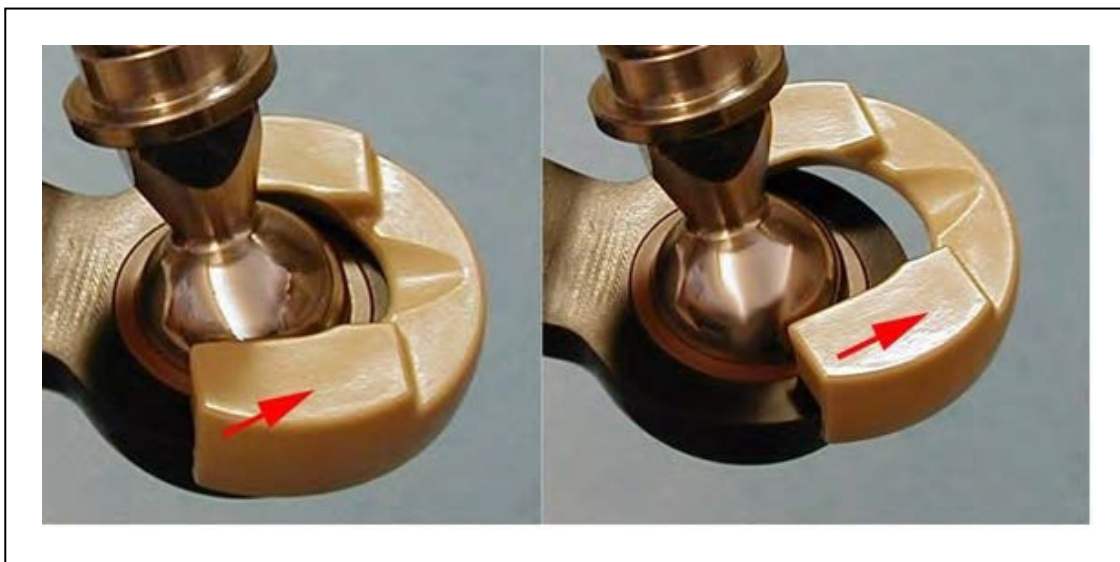
图 6-17. 拆除球头销锁
